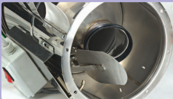
Sistema di scarico Discharged system
